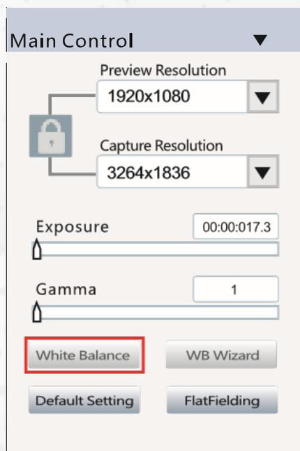
Para obter um melhor resultado de balanço de branco, mova a amostra para a área em branco e clique no botão "white balance" e, em seguida, mova novamente a amostra.
