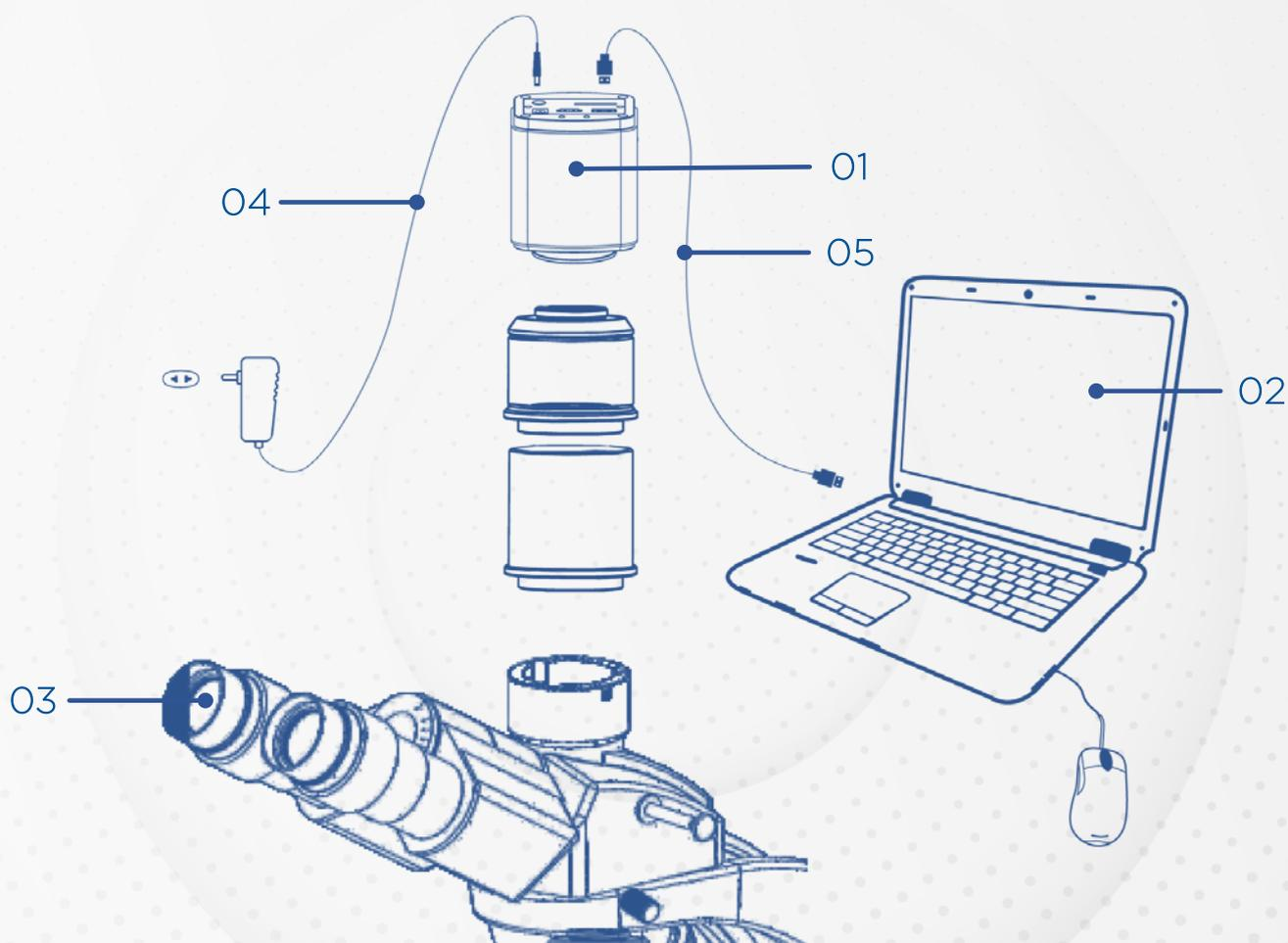
01 · Câmera CMOS HD    02 · Computador    03 · Microscópio
